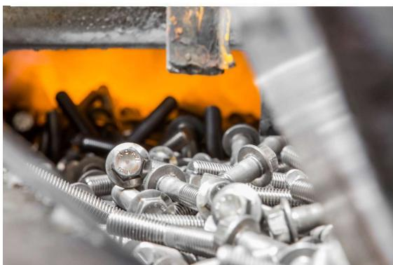
Metal veya alaşımılara istenilen özellikleri kazandırmak amacıyla katı halde uygulanan kontrollü ısıtma ve soğutma işlemleri olarak tanımlanır. Malzemenin akma ve kopma sınırını; sertliğini, tokluğunu iyileştirmek veya artık gerilmeleri gidermek için uygulanır.
